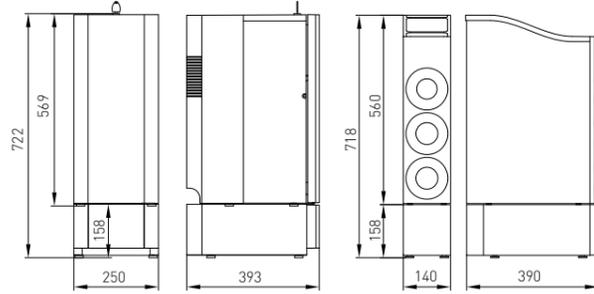
Beistellkühleinheit mit Unterstellereinheit
